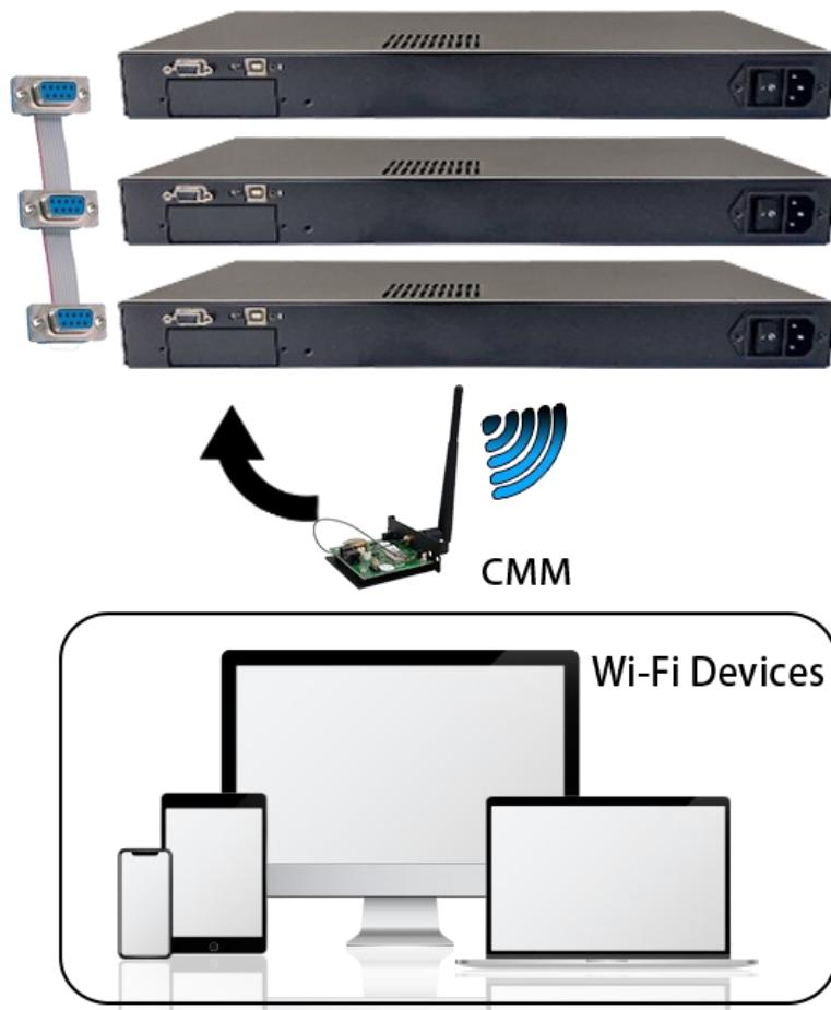
每一個金恩科技的標準充電系統出廠時，ID 的預設值均為1，然而當 CMM 同時連結多台時，每一台標準充電系統的 ID 不得相同，否則將導致系統衝突而無法動作，因此需要進行 ID 設定：
